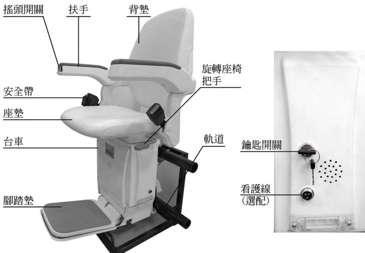
美利馳樓梯升降椅主要由4個組件所構成：分別是台車、腳踏墊、座椅和軌道。樓梯升降椅的動力來源是由台車內部的充電電池提供。左／右底護板、左／右擺頭護罩、擺臂罩以及腳踏墊底部都有安全傳感器。安全傳感器如果偵測到軌道上或是樓梯有障礙物，樓梯升降椅便會停止。在不使用樓梯升降椅時可以將腳踏墊、扶手及座墊收折起來，讓其他使用樓梯的人可以有更多的空間。當你到達樓梯頂端時，將旋轉把手向上拉，解開座椅鎖定裝置，便可將座椅旋轉至安全與方便進出的位置。在軌道的停車地點皆有充電站。當台車行經充電站時，將會自動停止，此時便會自動對電池進行充電。
